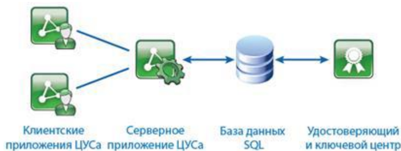
Рисунок 1 – Схема взаимодействия компонентов ViPNet Administrator 4
